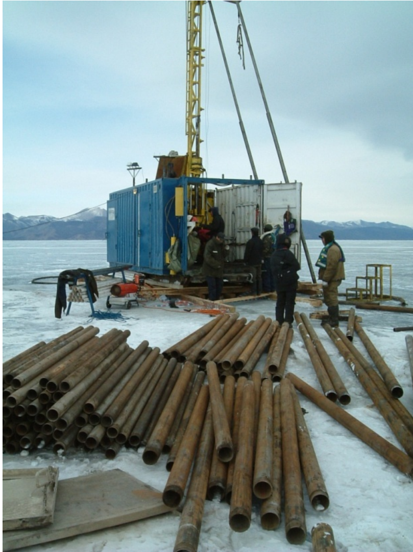
厳冬のフブスグル湖における 湖沼堆積物の掘削風景 (2008年3月)
