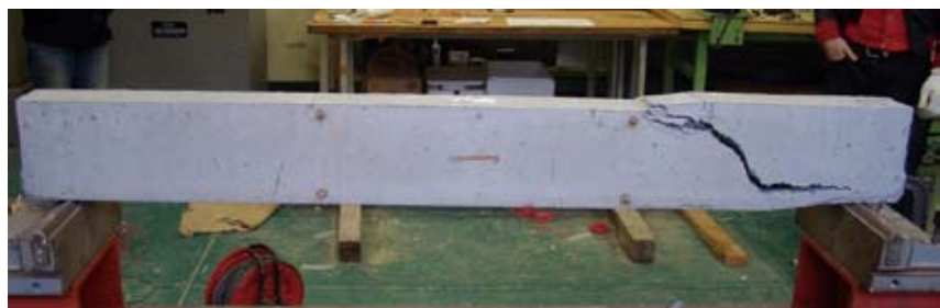
写真9: 通常の梁と錨鉄筋を用いた鉄筋コンクリート梁の破壊形状
