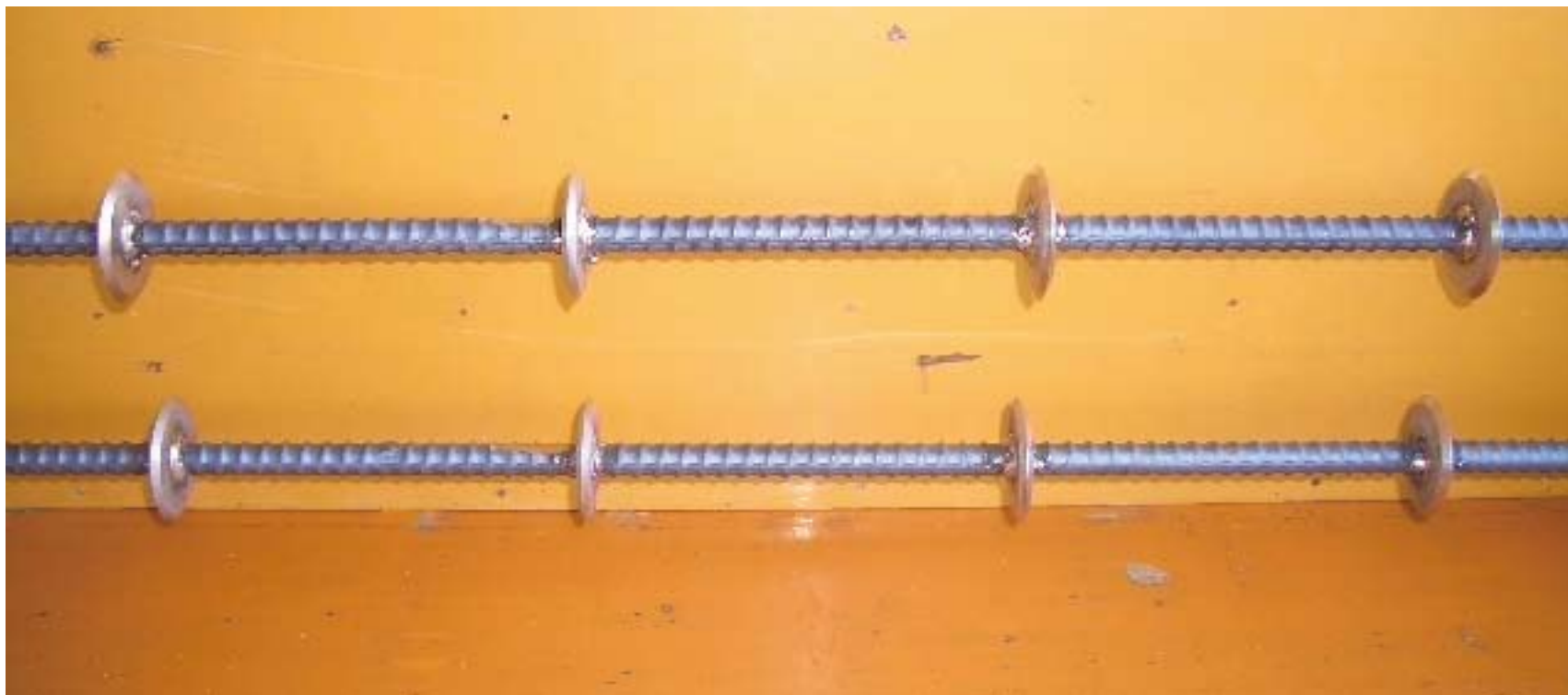
写真3: 異形鉄筋に錨のついた応力分散鋼材
