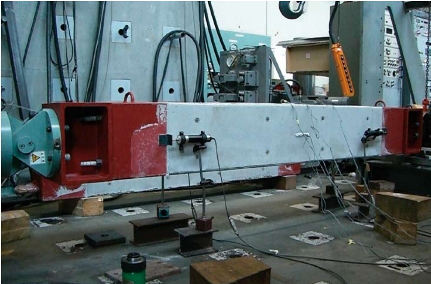
写真4 ひび割れ分散性能実験(直接引張試験)
