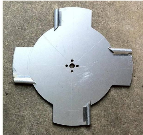
図9. 供試の前縁円筒の羽根車の写真
