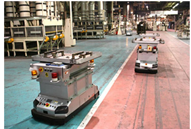
工場内搬送カート(AGV)
