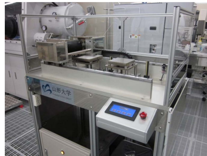
山形大学で開発した曲面印刷装置
