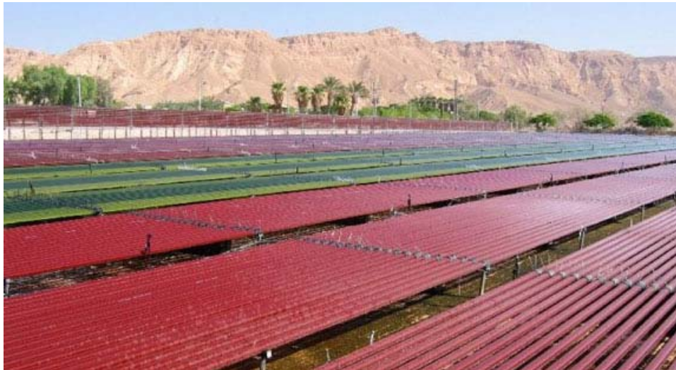
Algatech社のガラス管型培養槽
