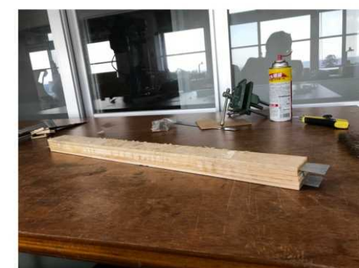
圧着後の試験体
