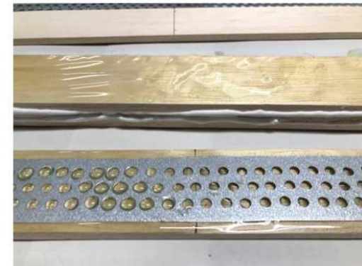
エポキシ樹脂の塗布
