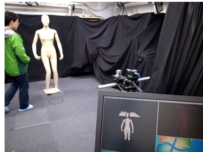
パターン投影方式による室内での計測
