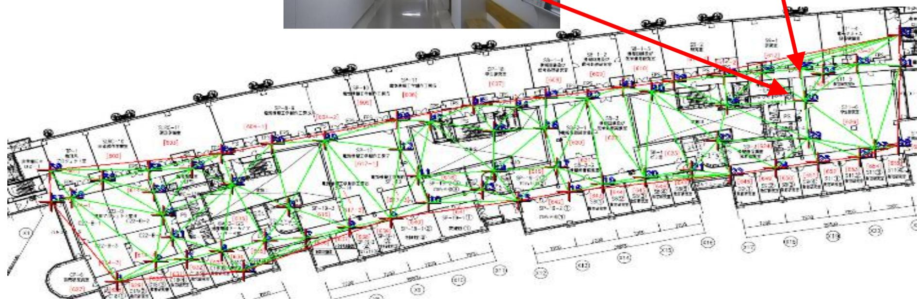
電波計測した箇所のマップ上の位置とドローン分割の様子
