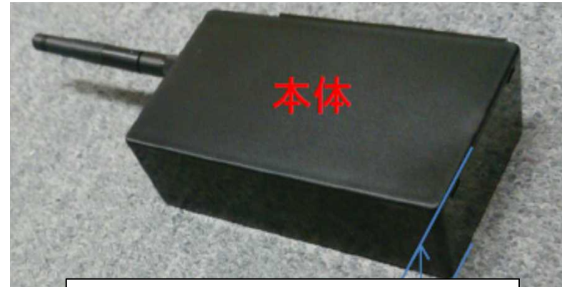
手のひらサイズの装置 125×70×40mm、重さ153g (バッテリー除く)
