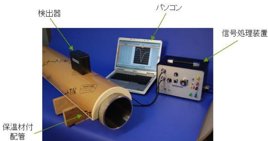
図-2 検査システムの構成
