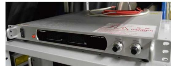
直流高電圧電源 (松定プレジジョン製)
