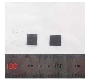
熱処理後のSnめっきCu板
