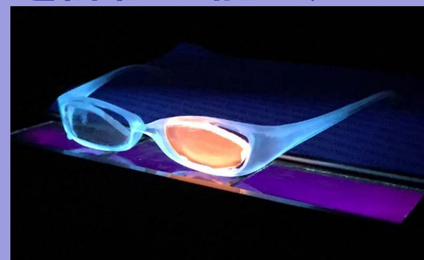
図. 3Dプリンタで出力したメガネ型ガラス線量計ホルダプロトタイプの場合
