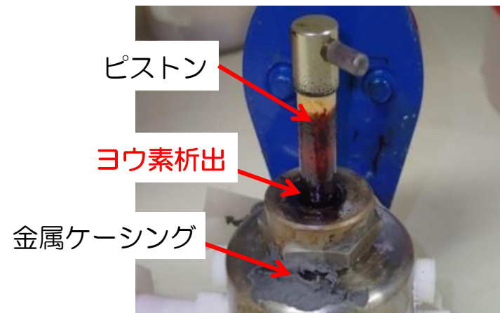
固着したポンプの外観
