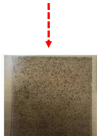
PPとCNF CNFが母材中に凝集
