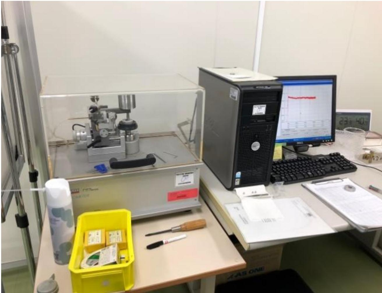
CSM instruments Tribometer 外観
