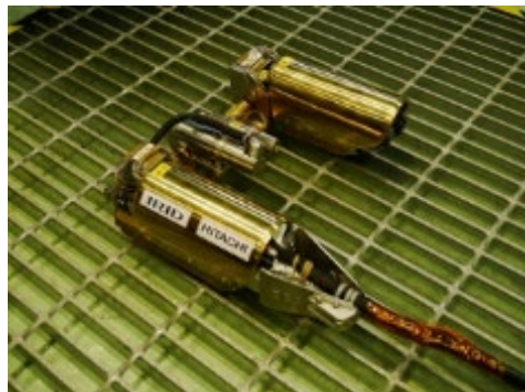
シリコン撮像素子を搭載した 格納容器内部調査装置 (IRID, HITACHI-GE)
