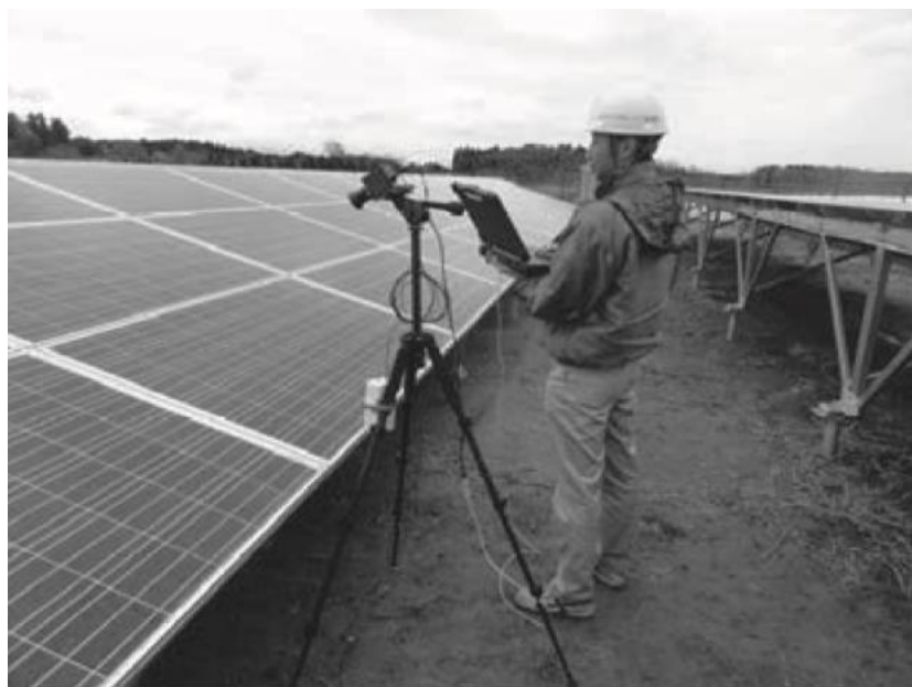
現場でのEL検査風景
