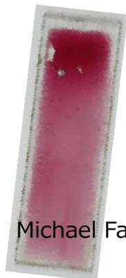
媒質に分散した金ナノ粒子はLSPRに基づく吸収 at 520 nm
