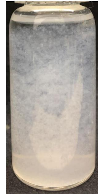
実験後容器から取り出したCNFカプセルを含む液
