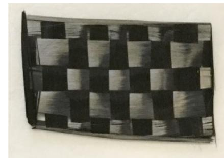
透明架橋体で作ったCFRP
