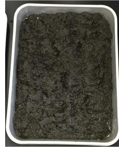
消化汚泥の処理（水洗、乾燥、粉末化）
