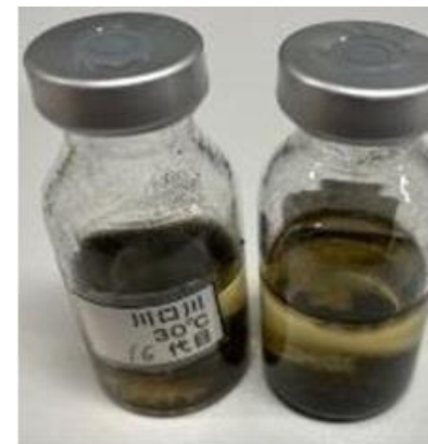
消化汚泥発酵試験
