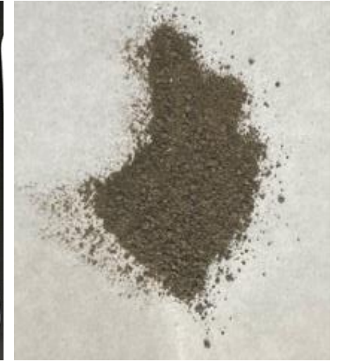
消化汚泥の処理（水洗、乾燥、粉末化）
