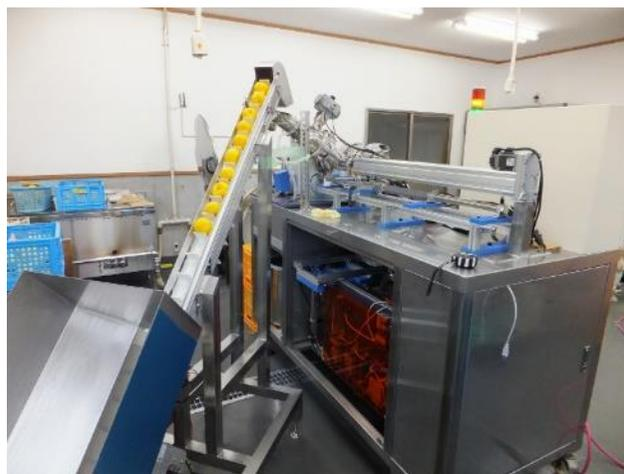
衝撃波処理による北限ユズの搾汁前処理装置
