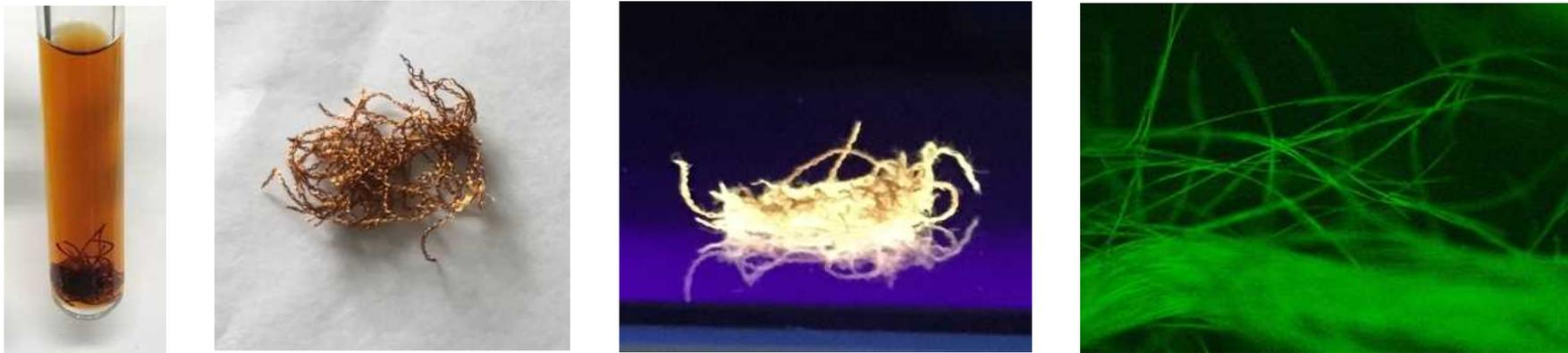
左から反応液、その後洗浄した糸、紫外線ランプによる蛍光、蛍光顕微鏡下での観察
