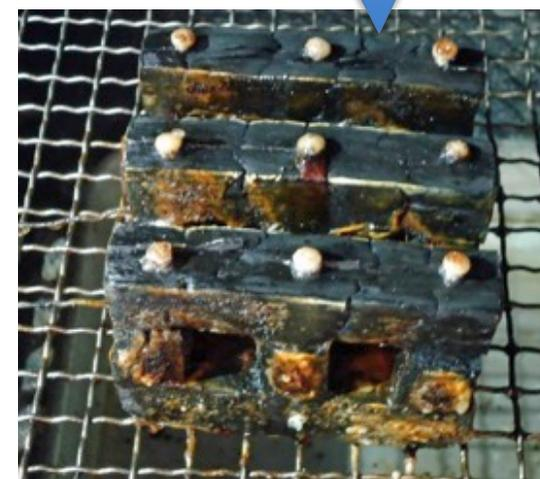
高圧洗浄器に充填した液体の消火剤を3.8L噴霧することで、A1サイズのク립を消火した。
