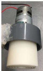
プラスチック製回転部を使用し、5回巻5000rpmのときの回収率は約65%
