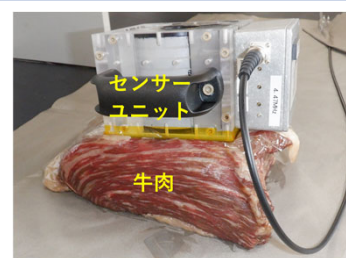
探査深度1cmの牛肉の霜降りスキャナーも開発済み (Ref 10)
