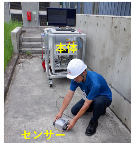
探査深度1cmのプロトタイプを試運転風景
