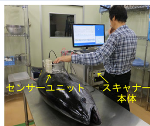
探査深度1cmのマグロのトロのスキャナーは開発済み (Ref 9)
