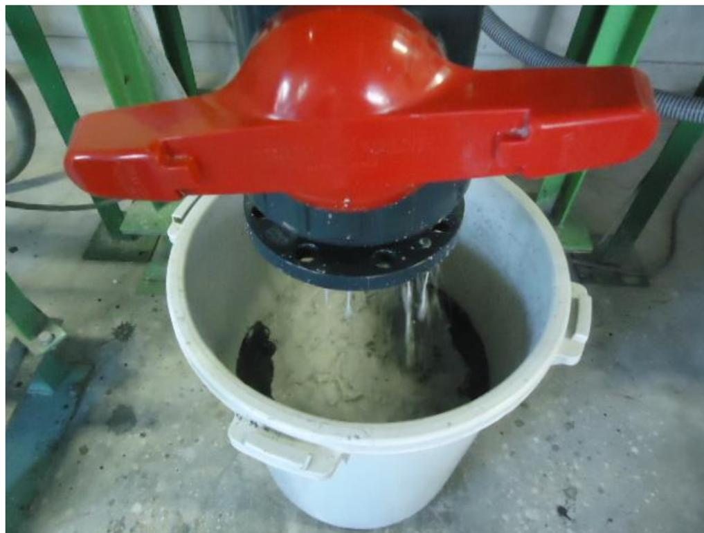
図 洗浄済み石炭灰回収時の様子
