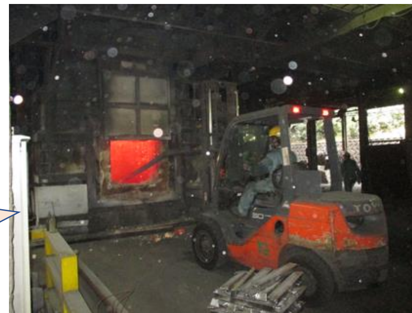
現場でのフラックス攪拌
