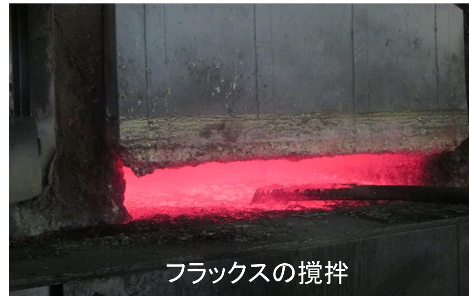
溶湯表面に投入されたフラックス
