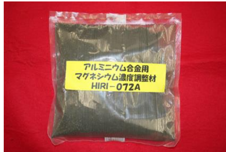
開発したMg濃度調整用フラックス
