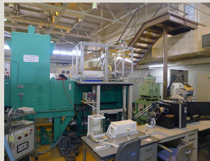
20年以上前に作られた装置に多関節ロボットを導入し、分析の完全自動化を実現
