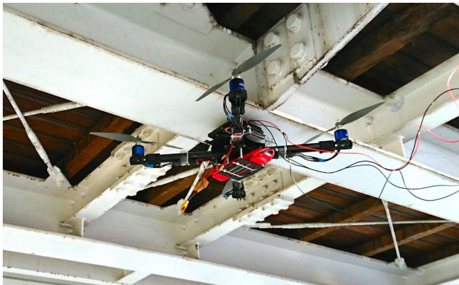
↑ 構造物吸着テストの様子
