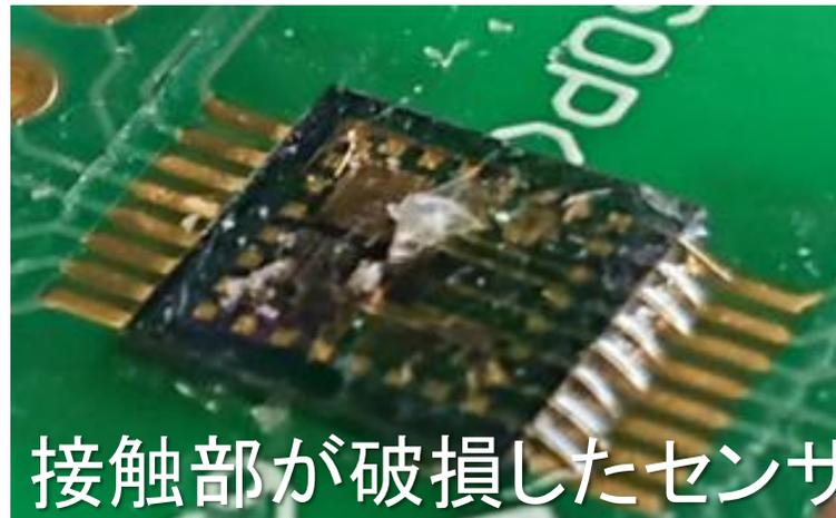
接触部が破損したセンサ
