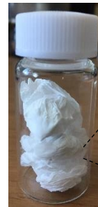
電界紡糸により調製した ナノファイバーマット
