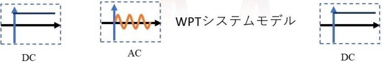
負荷変動・コイルの位置ずれによりスイッチング条件・出力が変動
