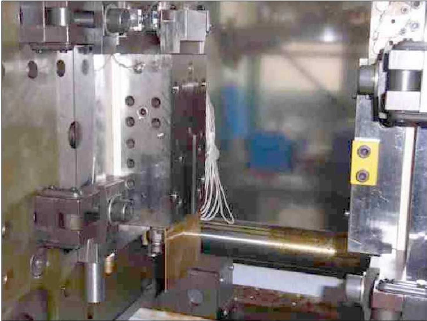
図5 樹脂粘度測定金型②
