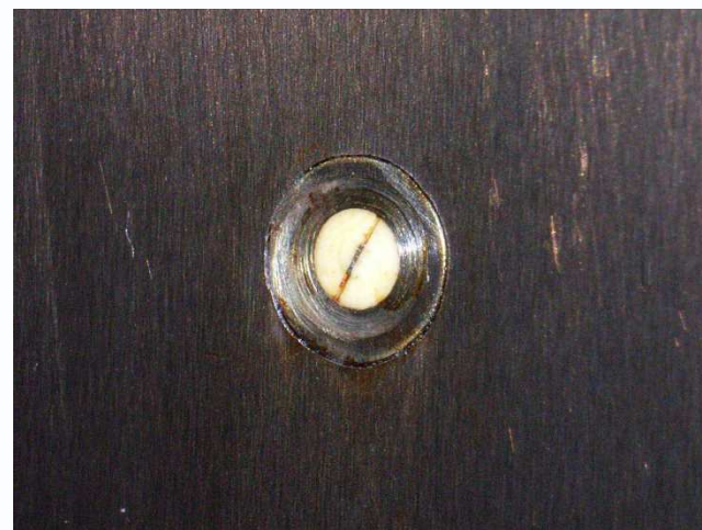
接点むき出し式熱電対 (メーカー製)
