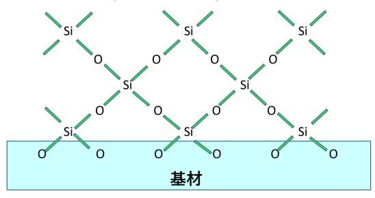
ポリシラザンは加熱により 大気の水分と化学反応し、 良質な SiO<sub>2</sub> 膜にシリカ転化 させることが可能
