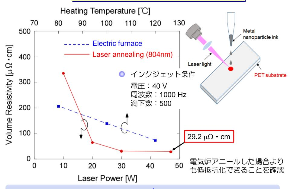
レーザ出力47W ⇒ 29.2 μΩ • cm 🔷 PET基板上でも低抵抗化可能
