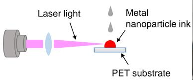
金属ナノインクの着弾 及びレーザ光の照射
