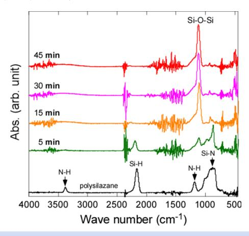
飽和水蒸気圧下で加熱処理を行うことで、100 ℃ 程度の低温かつ 短時間で完全なシリカ転化が可能であることを示している。
