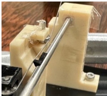
1軸の試験装置 L = 40\text{mm}
