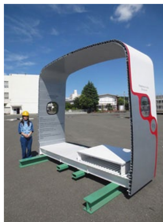
高速鉄道車両部分構体の試作
