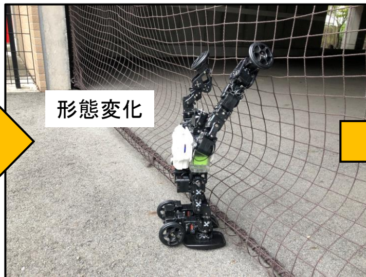
平地移動から登攀移動に 形態を切り替え
