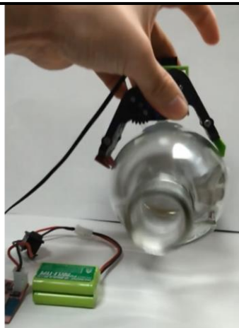
グリップによる把持と吸盤による吸着の同時実行
