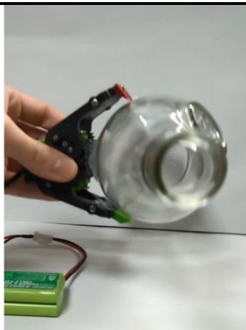
グリップによる把持と吸盤による吸着の同時実行
