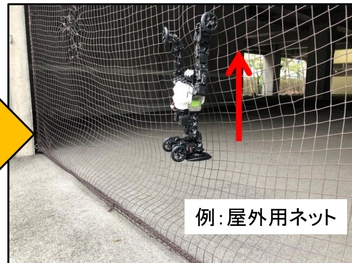
吸盤併用グリッパ による登攀移動
