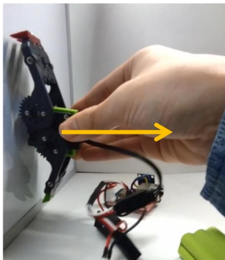
(a) 矢印方向に引っ張ることによる 吸盤の取り外しが困難
