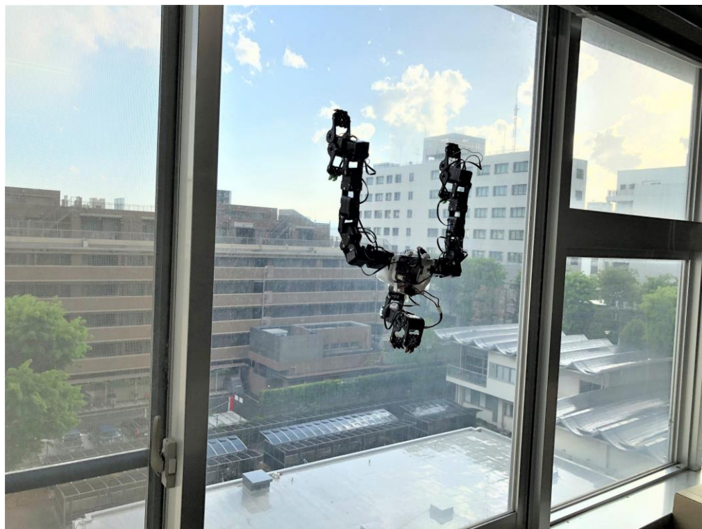
吸盤の吸着による窓への張り付き
