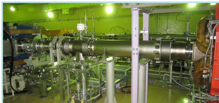
J-PARC加速器のビームライン ( チタン製 のビームパイプやベローズ)
