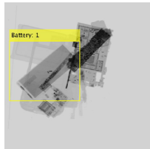
廃棄物に混入した電池
