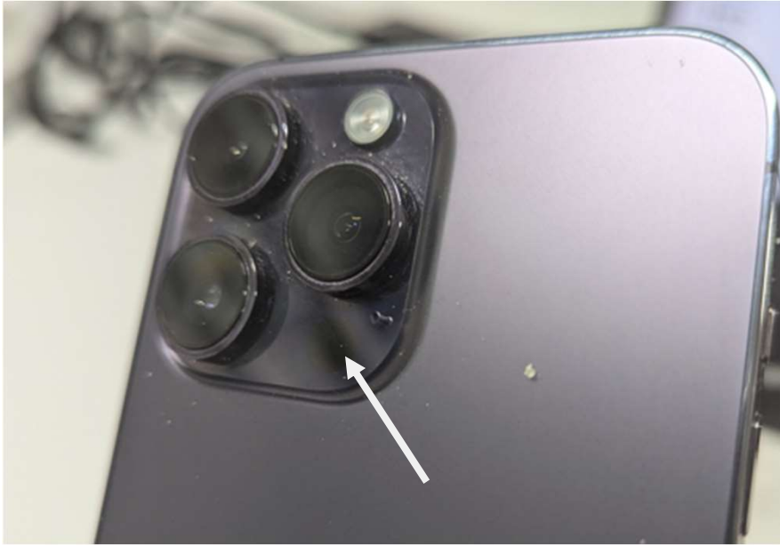
iPhoneに搭載されているLiDARスキャナ
