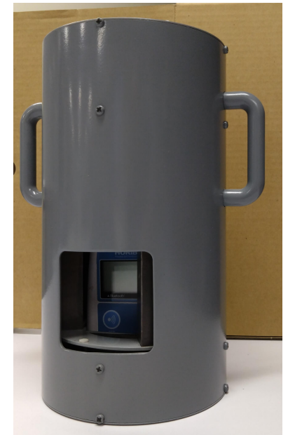
組み込み式の計測器(試作) 径130mm×240mm
