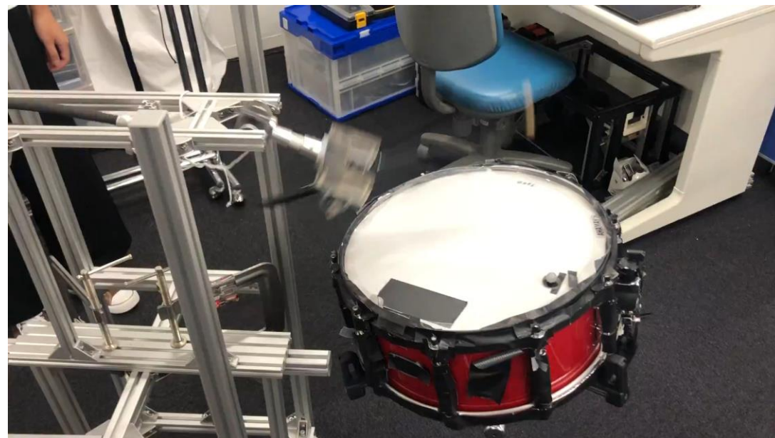
強化学習による筋骨格打楽器演奏ロボットの動作
