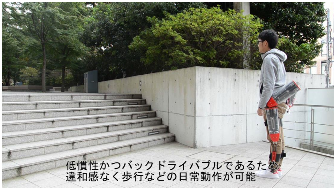
人工筋肉と磁気粘性流体を用いたアシスト装置
