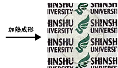
修復したゴムシート
