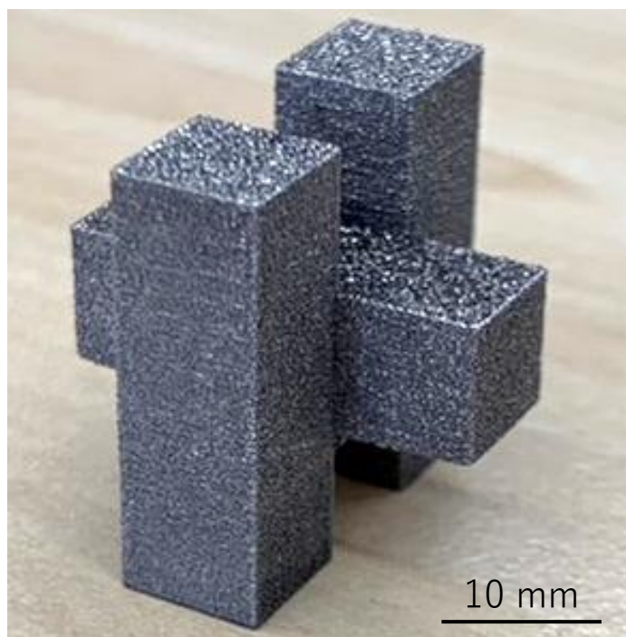
ルービックキューブ形状 Ti-6Al-4V試験片
