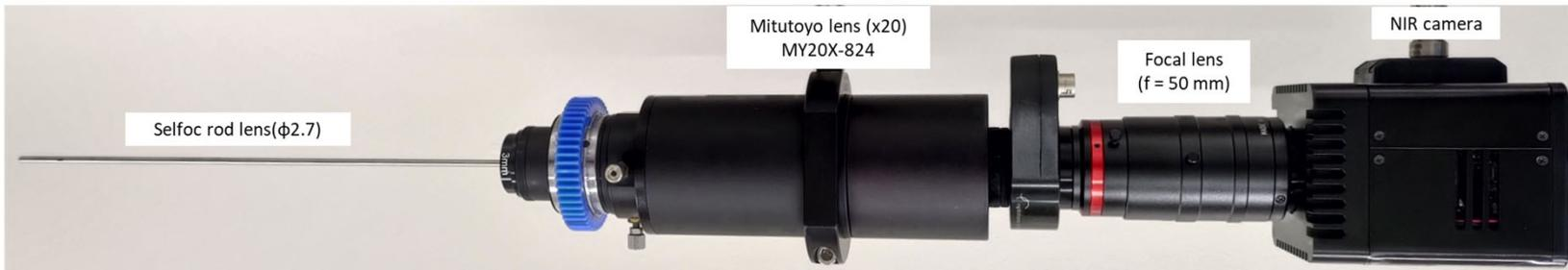
硬性鏡の設計で顕微鏡倍率のNIR-HSIが取得可能
