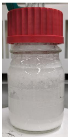
白色沈殿 (カルバミン酸 誘導体)
