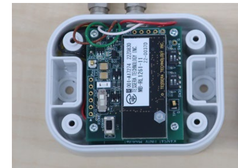
蓄電データ送信モジュール [2023年度試作品] (W52mm×D65mm×H27mm)
